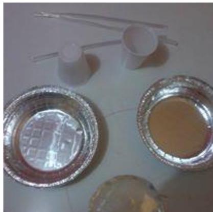
**Figura 2:** Materiais disponibilizados para a montagem do eletróforo: vasilhas de alumínio (marmitta), copos plásticos, capas de encadernação (plástico), cola quente, tesoura, palitos de madeira. Fonte: próprio autor
