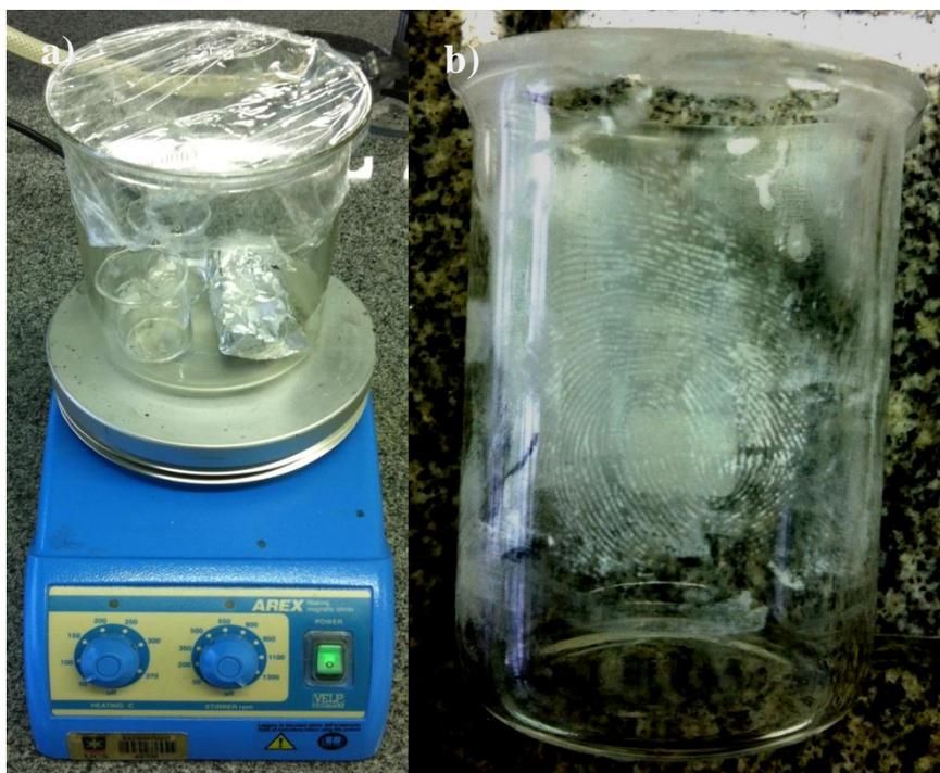
**Figura 5:** Aparato utilizado (a) para obter a impressão digital através do vapor de cola (b).
