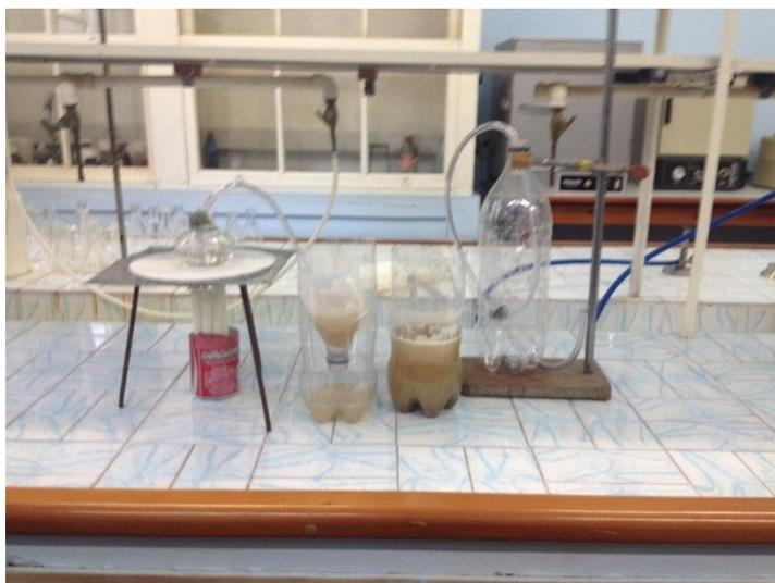
**Figura 2** - Dissolução Fracionada, filtração e destilação simples.
