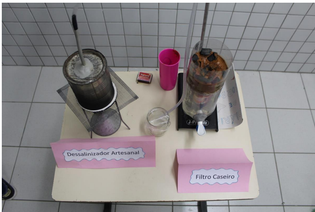
Figura 05 – Proposta de dessalinizador artesanal e filtro caseiro construídos pelos alunos Fonte: Arquivo pessoal
