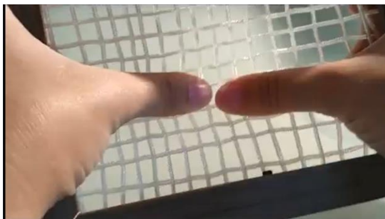
Figura 2. Rede construída com músculos artificiais entrelaçados.
