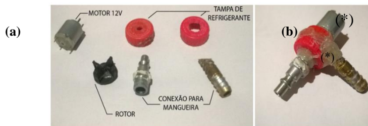
Fig. 4 – Construção da bomba d’água. Em (a) materiais utilizados; em (b) Motor finalizado.
