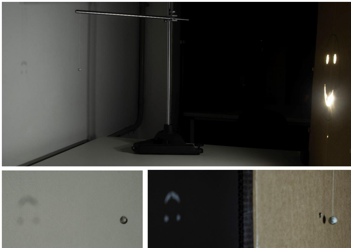
Figura 4 – Na imagem superior, uma esfera pequena, suspensa por um fio, interposta entre uma parede e uma fonte de luz difusa, na forma de olhos e boca, projeta uma sombra que é uma réplica fiel (mas invertida) desta fonte. A imagem inferior, à esquerda, é uma ampliação da esfera e da sombra da imagem superior; a imagem inferior direita é a projeção luminosa, através de um orifício efetuado em um papelão interposto, da fonte de luz, configurando assim uma câmara escura. A imagem inferior esquerda parece “o negativo” da imagem inferior direita. A esfera aparece apenas como referência, e não influi na projeção da sombra.
