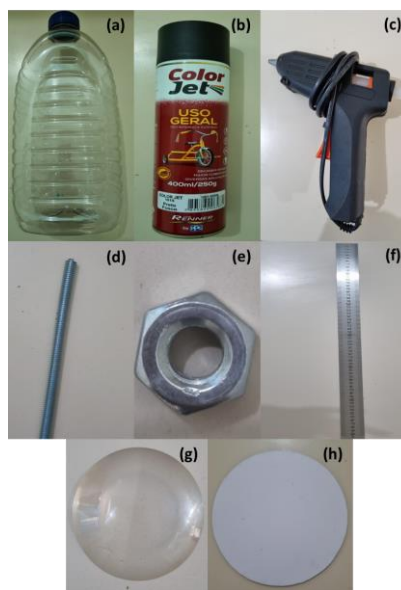
Figura 1 – Materiais para montagem do simulador do olho humano
