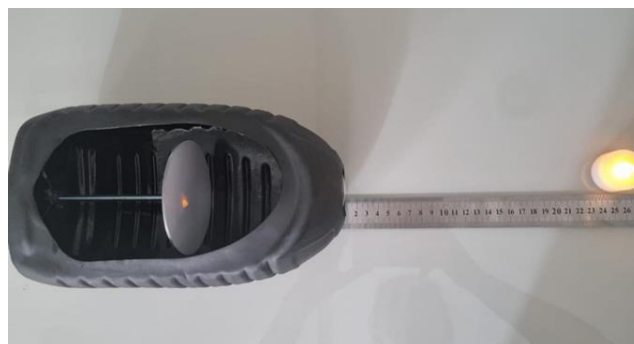
Figura 5 - Simulador físico do olho humano
