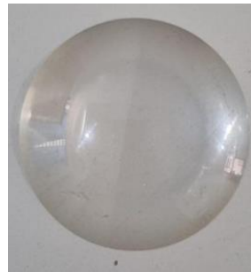
Figura 4 – Lente convergente que simula o cristalino
