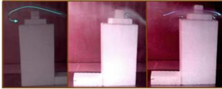
**Figura 10:** Flujo de viento sobre diferentes configuraciones del techo de un edificio.
