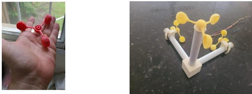
**Figura 12:** Izquierda: coperola individual. Derecha: Sistema de tres anemómetros montados en tres planos perpendiculares.
