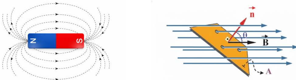
Figura 7: Representação esquemática (a) das linhas de campo magnético e do (b) do fluxo magnético \Phi passando por uma determinada área A . Fonte: Imagem gerada por Inteligência Artificial (Google Gemini), elaborada pelos autores.
