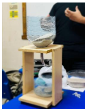
Figura 1 - Análogo mecânico de buracos negros construído com garrafa PET, areia e suporte de madeira
