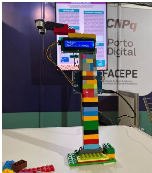
Figura 1: Protótipo físico construído em estrutura modular de LEGO contendo o sensor ultrassônico HC-SR04, o display LCD 16×2 e o microcontrolador Arduino Uno utilizado no experimento de reflexão sonora. (Fonte: o autor.)
