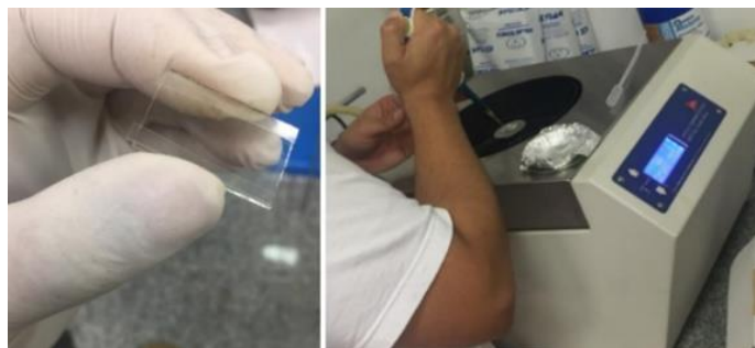
Figura 9. Deposição do filme de PVA e posicionamento dos espaçadores na preparação da célula.
