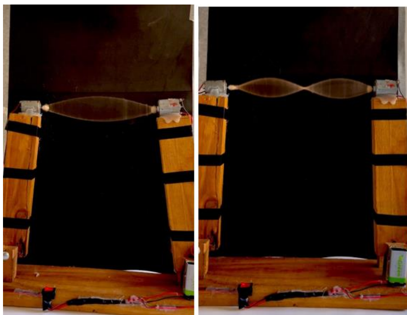
Figura 6: Experimento de onda estacionária em corda Fonte: registros dos autores em 2024.
