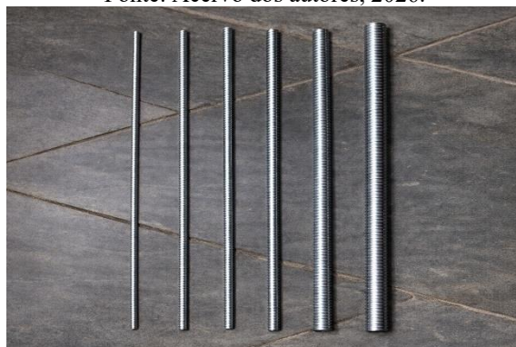
Figura 2 - Barras de \frac{3}{16} ; \frac{1}{4} ; \frac{5}{16} ; \frac{3}{8} ; \frac{5}{8} .
