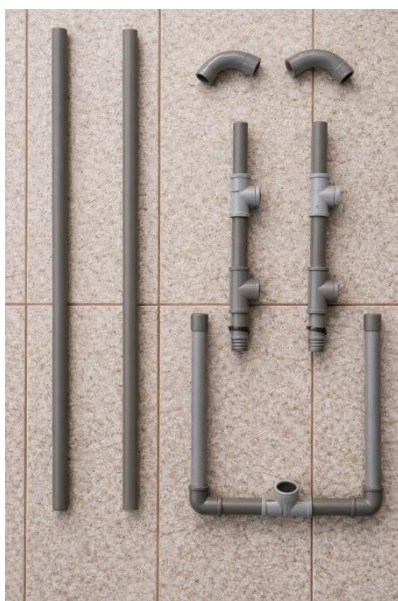
Figura 13 - Peças para montagem do aparato Massa- Mola ou Pêndulo - Cono de PVC Marrom 25 mm.
