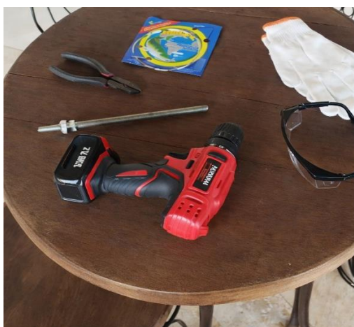
Figura 12 - Parafusadeira, barra rosca e porca, luvas, óculos de proteção, alicate de corte e fio de aço inoxidável nº 26
