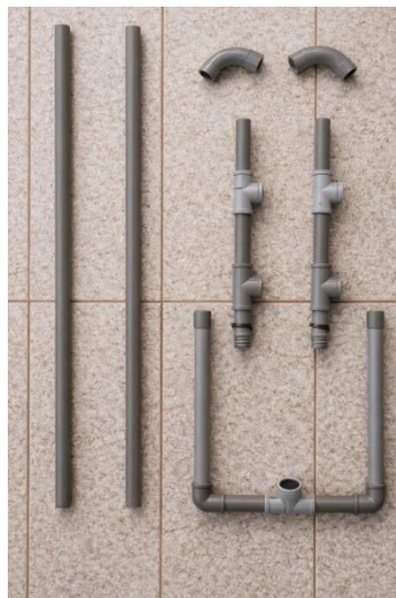
Figura 8 - Peças para montagem do aparato Massa - Mola ou Pêndulo - Cono de PVC Marrom 25 mm. Fonte: Acervo dos autores, 2026.
