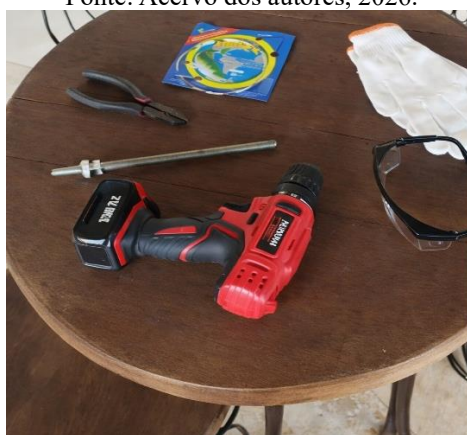
Figura 5 - Parafusadeira, barra rosca e porca, luvas, óculos de proteção, alicate de corte e fio de aço inoxidável nº 26. Fonte: Acervo dos autores, 2026.
