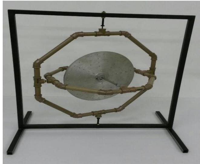
**Figura 7** - Giroscópio finalizado.
