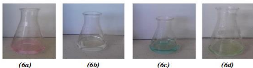
Figura 6. Cor do extrato de repolho roxo em diferentes meios de pH observado pela titulação do ácido fraco por base forte
