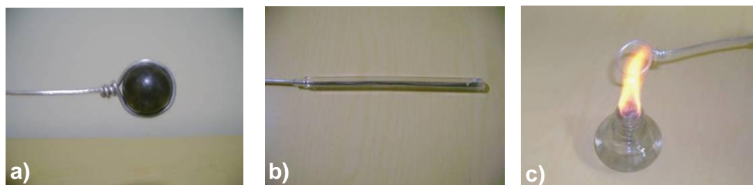
Figura 5 – Dispositivo construído para mostrar a dilatação de um anel. (a) A esfera não passa pelo anel. (b) Extremidade isolada com o plástico de uma caneta. (c) O anel sendo aquecido.
