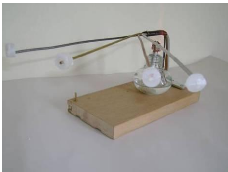
Figura 9- Dispositivo construído para mostrar a transmissão de calor por condução nos diferentes materiais.
