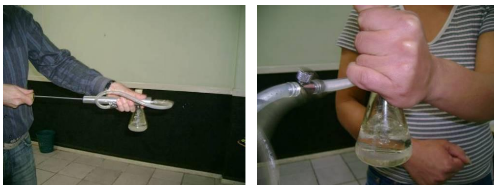
Figura 15 – Dispositivo construído para mostrar a influência da pressão na temperatura de ebulição.
