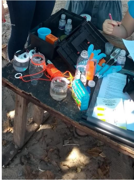
Figura 3. A maleta de experimentos com os materiais necessários para a coleta de água, medições e testes químicos. Fonte: autores.
