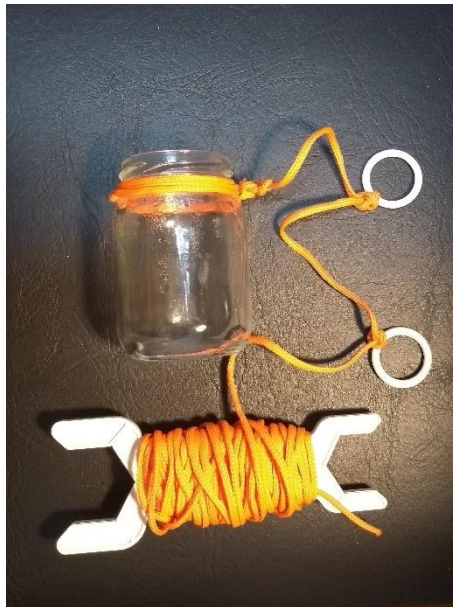
Figura 5. Sonda para a coleta da água da praia confeccionada com um pote de vidro, corda, argolas para medir as profundidades (15 cm e 30 cm) e suporte plástico para controlar o lançamento. Fonte: autores.
