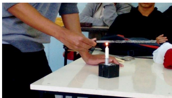
Figura 8 - Participação dos alunos na demonstração 1C de propagação de calor por condução.
